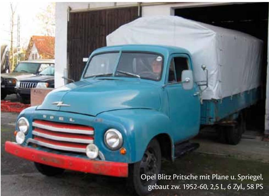
Opel Blitz Pritsche mit Plane u. Spriegel, gebaut zw. 1952-60, 2,5 L, 6 Zyl., 58 PS
