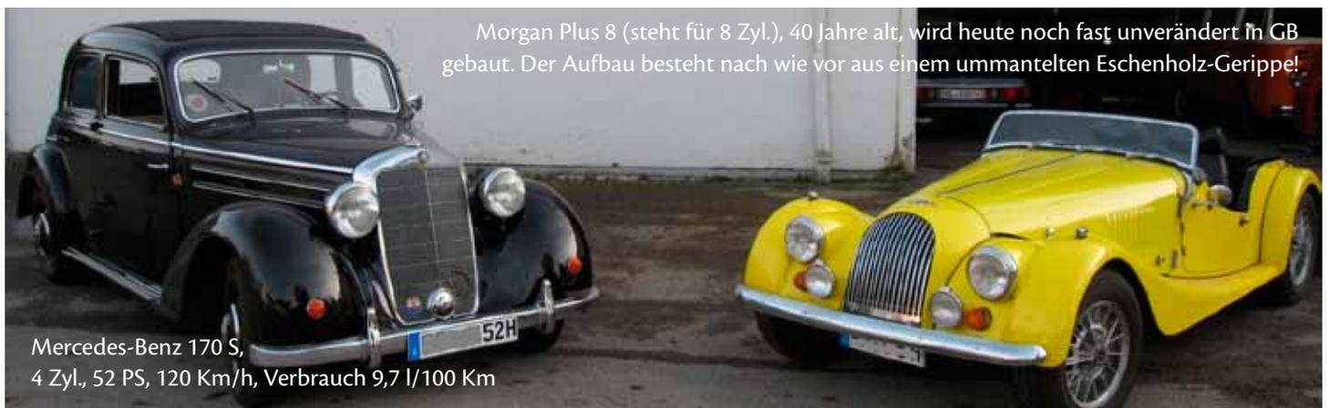
Morgan Plus 8 (steht für 8 Zyl.), 40 Jahre alt, wird heute noch fast unverändert in GB gebaut. Der Aufbau besteht nach wie vor aus einem ummantelten Eschenholz-Gerippe!
